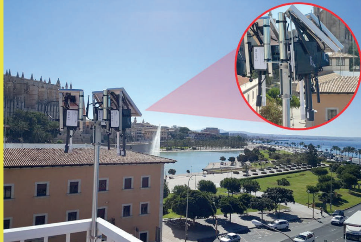
Figura 2. Sensor ambiental IoT instal·lat a la seu de l'Autoritat Portuària de Palma
